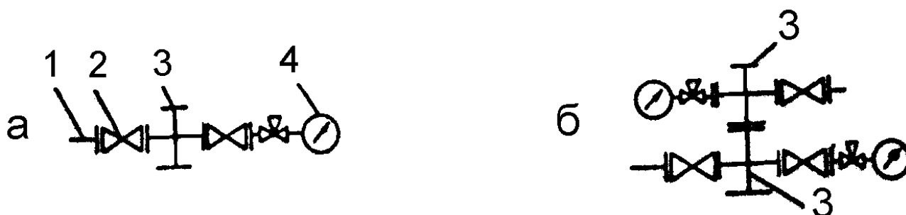
Рисунок 2 - Схемы трубных обвязок фонтанной арматуры:
