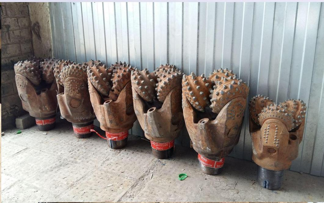
В зависимости от числа рабочих органов шарошечные долота бывают одно-, двух-, трех-, четырех-, шести- и многошарошечные. Наиболее распространен трехшарошечный вариант долота. Конструкция такого долота отличается наилучшей вписываемостью в круглое сечение скважины трех конических шарошек, обеспечивающих оптимальное центрирование и устойчивость долота.
