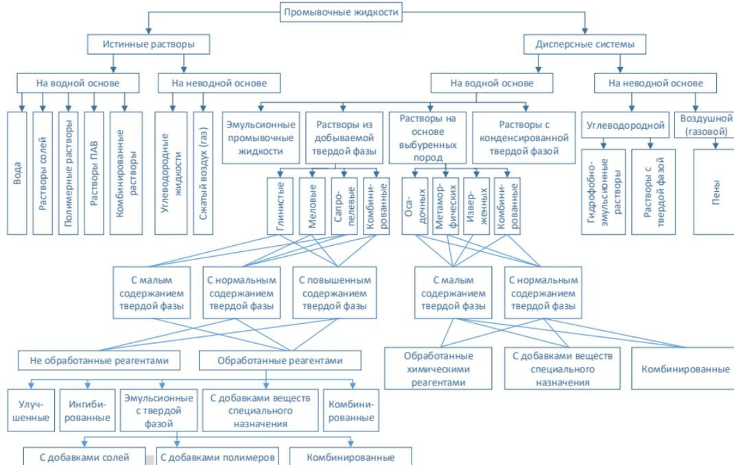
Типы очистных агентов далее можно подразделять на различные виды в зависимости от степени и состава минерализации всей системы или её дисперсионной среды, количества дисперсной фазы, способа приготовления БР и т.д.
