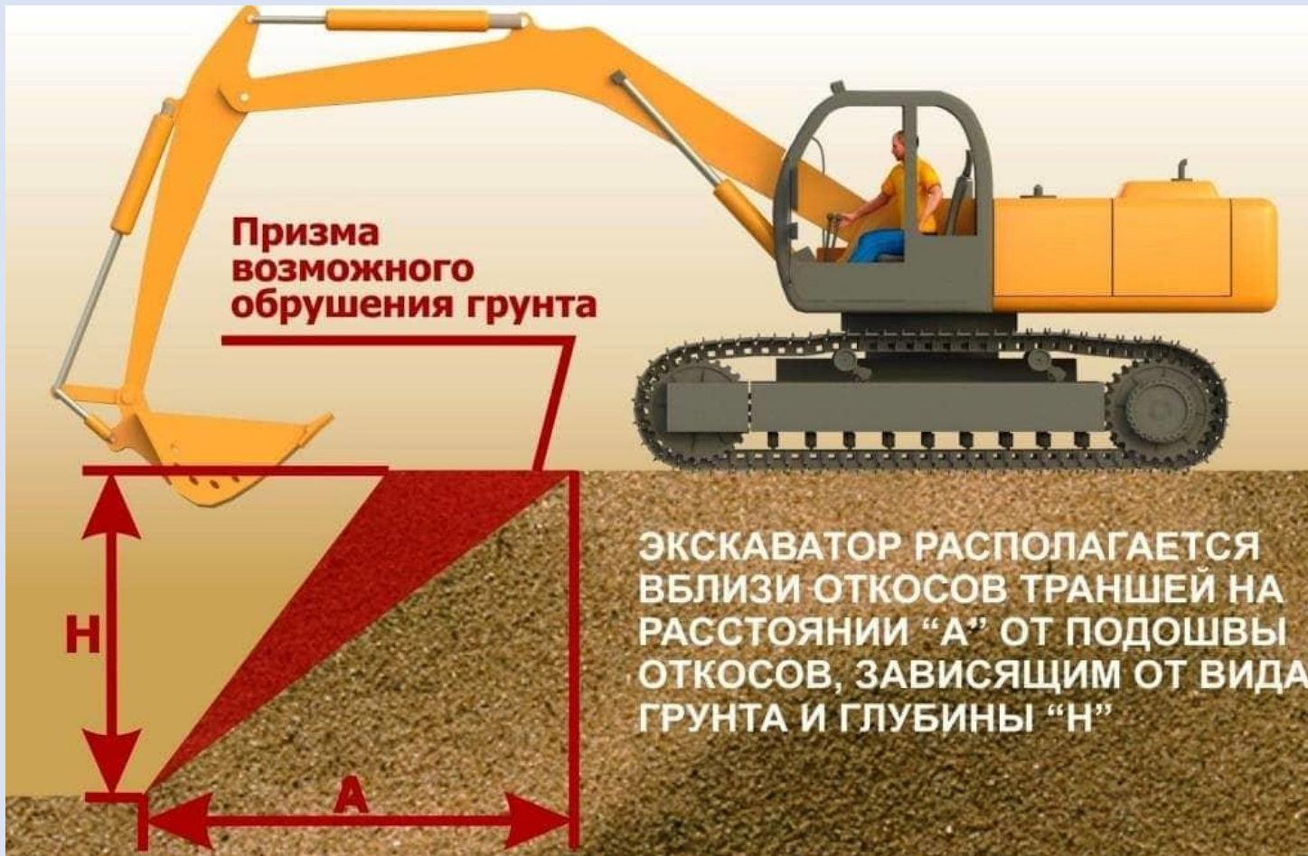
Установка и работа экскаватора вблизи траншеи (котлована)
