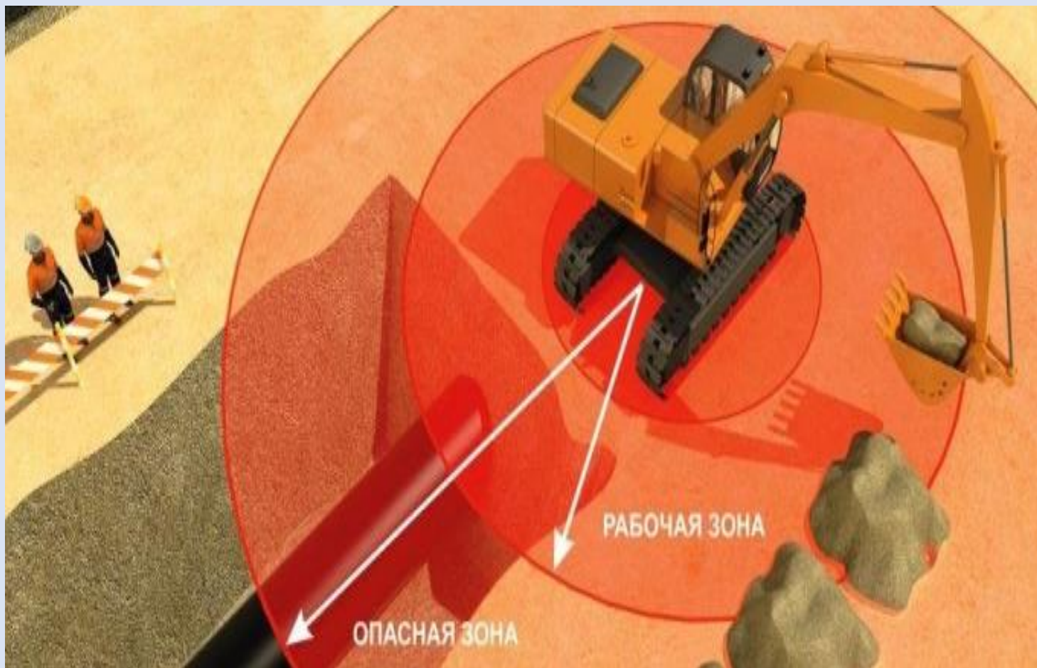
Опасные зоны при работе экскаватора
