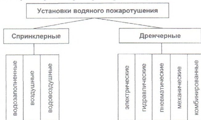
Рис. 10.18. Виды установок водяного пожаротушения
