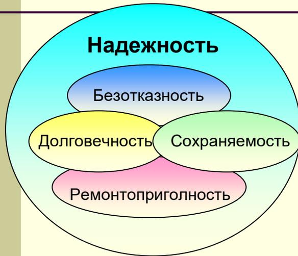
**Безотказность** - свойство объекта непрерывно сохранять работоспособное состояние в течение некоторого времени или некоторой наработки.
