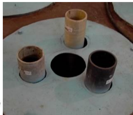
Схема и фото комплекта трубных волноводов для аппаратуры АК
