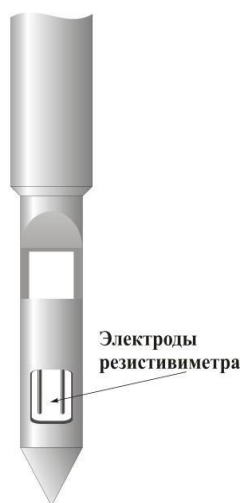
Рисунок 7 – Токковый резистивиметр прибора К-3
