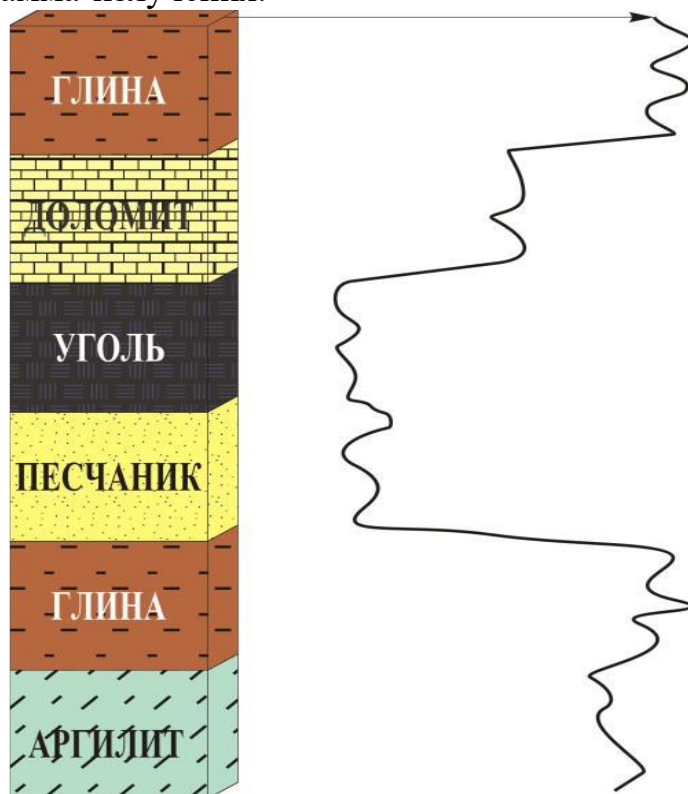
Рисунок 8 – Диаграмма ГК против пород разной литологии
