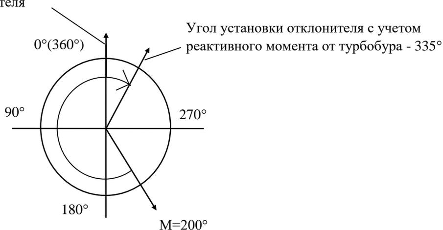
Рис. 10. Пример определения величины угла поворота отклоняющего устройства
