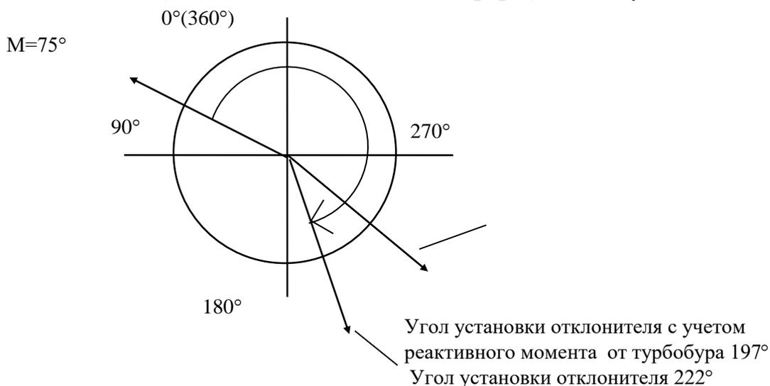
Рис. 15. Пример определения величины угла поворота отклоняющего устройства
