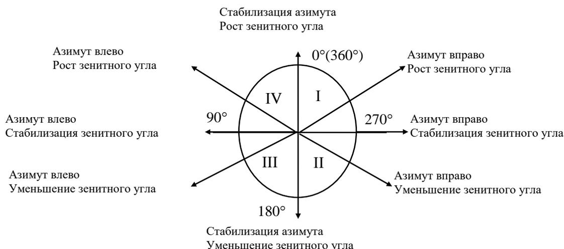
Рис. 8. Сечение ствола скважины в плоскости действия отклоняющего устройства
